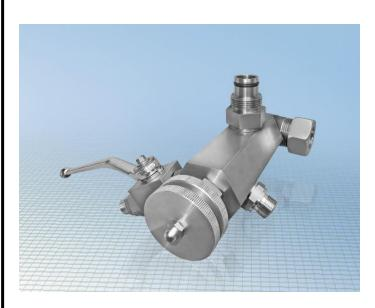
Das Haupteinsatzgebiet sind Spritzeinrichtungen mit Materialvorwärmung. Hier wird das erwärmte Material im Kreislauf gefahren und auf Temperatur gehalten. Nur bei Materialabnahme wird kaltes Material aus dem Vorratsgebinde entnommen. So wird der Energieverbrauch minimiert und eine gleichbleibend vorgewärmte Temperatur erreicht ohne den Materialvorrat komplett zu erwärmen.
