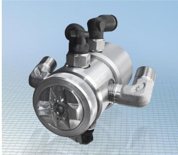
Pneumatisch betätigte Spritzpistole für automatisierte luftunterstützte Airless Applikationen. Der Pistolenkörper ist im Materialbereich aus Edelstahl und im Antriebsbereich aus Aluminium. Damit ist die KS-AKP 425 nicht nur für lösemittelbasierende Materialien bestens geeignet, sondern auch universell für Anwendungen mit wasserbasierenden Materialien einsetzbar. Durch die Verwendung von Aluminium ist der Spritzautomat 530 Gramm leicht und als Roboterpistole bestens geeignet.
