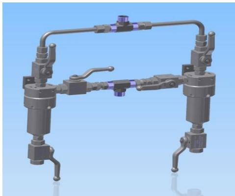
Das Doppelsieb mit 4 Stück 2/2-Wege Kugelhahn zur Umschaltung zwischen den Filtern. Diese Variante zeichnet sich durch einen deutlich günstigeren Preis aus. Der Materialeingang ist von unten, der Materialausgang am oberen Kugelhahn. Materialein- und Ausgang haben in der Grundversion ein 3/8" Innengewinde, welches mit Anschlussnippeln für die gewünschte Anlagenverbindung versehen werden kann. Materialberührte Teile aus Edelstahl.
